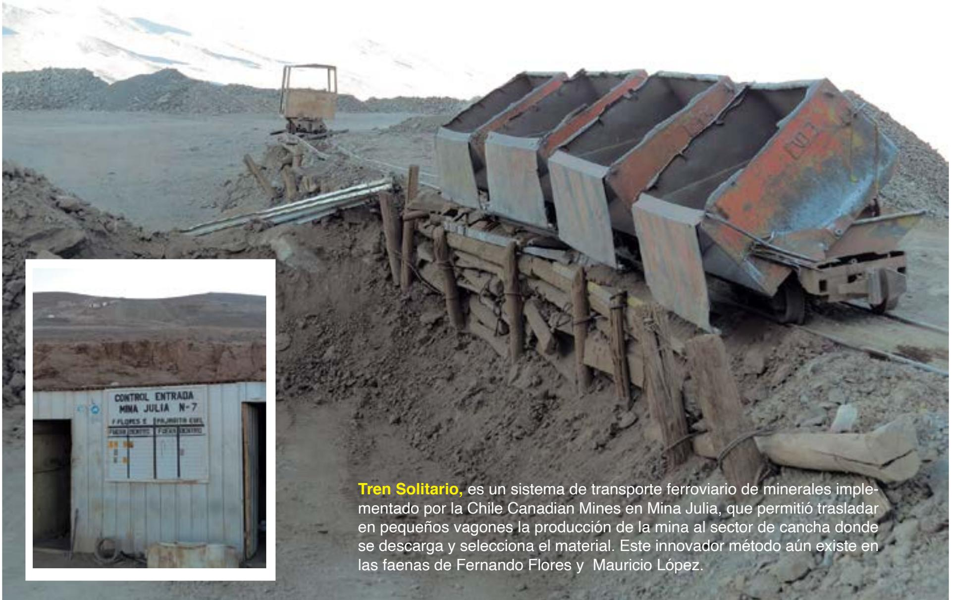
**Tren Solitario**, es un sistema de transporte ferroviario de minerales implementado por la Chile Canadian Mines en Mina Julia, que permitió trasladar en pequeños vagones la producción de la mina al sector de cancha donde se descarga y selecciona el material. Este innovador método aún existe en las faenas de Fernando Flores y Mauricio López.
